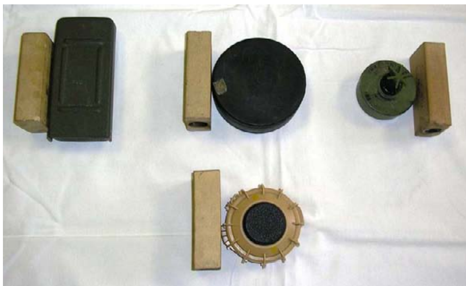
Slika 6 - Pozicije postavljanja eksplozivnog naboja na protupješačke nagazne mine Gornji red : PMA-1, PMA-2; PMA-3 (slijeva na desno) Donji red : VS-50
