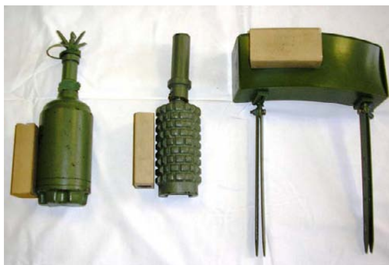
Slika 7 - Postavljanje eksplozivnog naboja na protupješačke rasprskavajuće mine i MRUD PROM-1, PMR-2AS i MRUD
