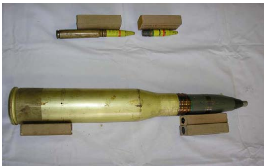
Slika 15 – Metak sa TZOG i topnički metak Gore: 20 mm metak sa TZOG, 20mm TZOG Dolje: Topnički metak pozicije e/n
