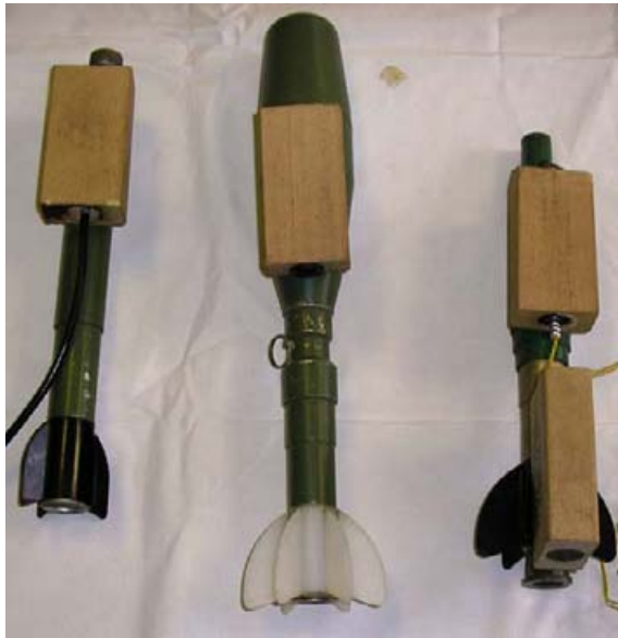
Slika 11 – Uništavanje tromblonskih mina TTM M60, KTM M60 i TTM sa dopunskim punjenjem
