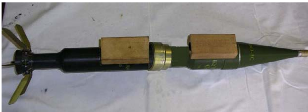
Slika 19 - Pozicije postavljanja eksplozivno naboja ukoliko raketni motor nije izgorio
