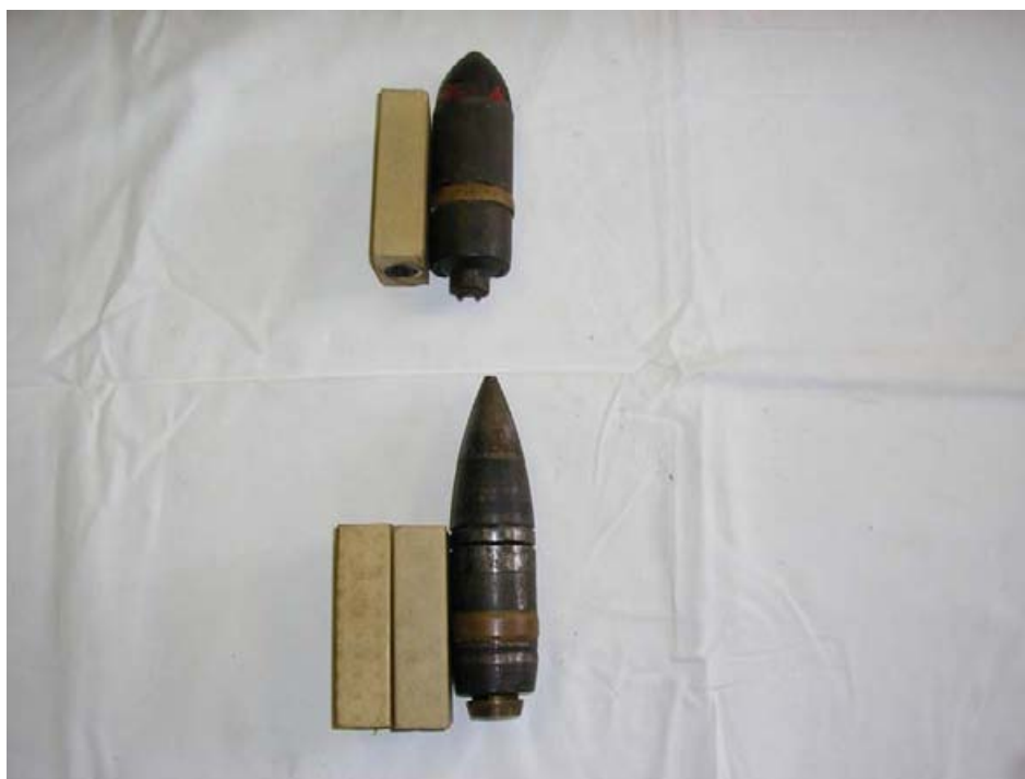
Slika 16 – Uništavanje pancirnih zrna
