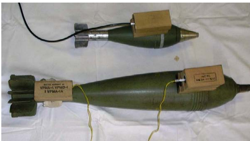
Slika 13 - Minobacačke mine 82 mm MB mina i 120 mm MB mina sa osnovnim i dopunskim punjenjem
