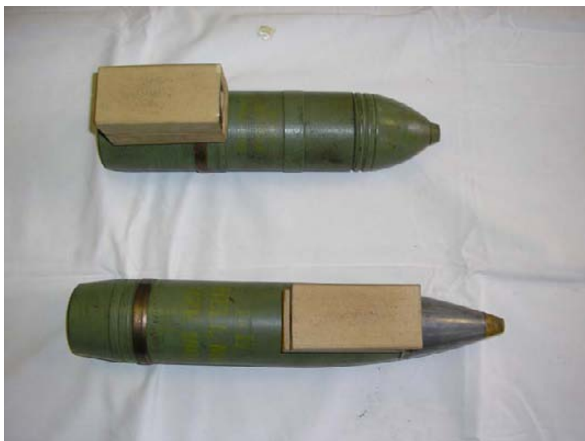
Slika 14 – Uništavanje kumulativnog zrna i granata Kumulativno zrno (gore) TF granata (dolje)
