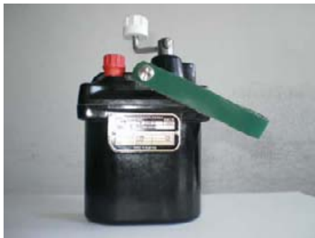
Slika 1- Mašina za paljenje električnog naboja SCHAFFLER Type 818 – snage 1000V
